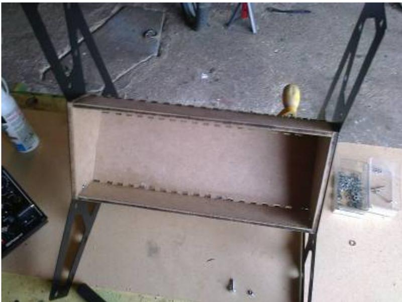
Puis le résultat final montage dans l'étagère du synthétiseur, avec assemblage de l'étagère et vissage des modules additionnels :
